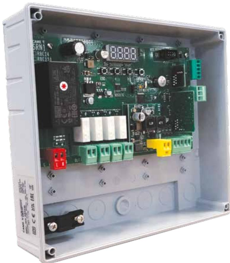
**RBE Plus** ist die neue Steuereinheit für die Zugangskontrolle, die mit den Handsendern und dem gesamten CXN BUS-Zubehör von CAME verwendet werden kann.
