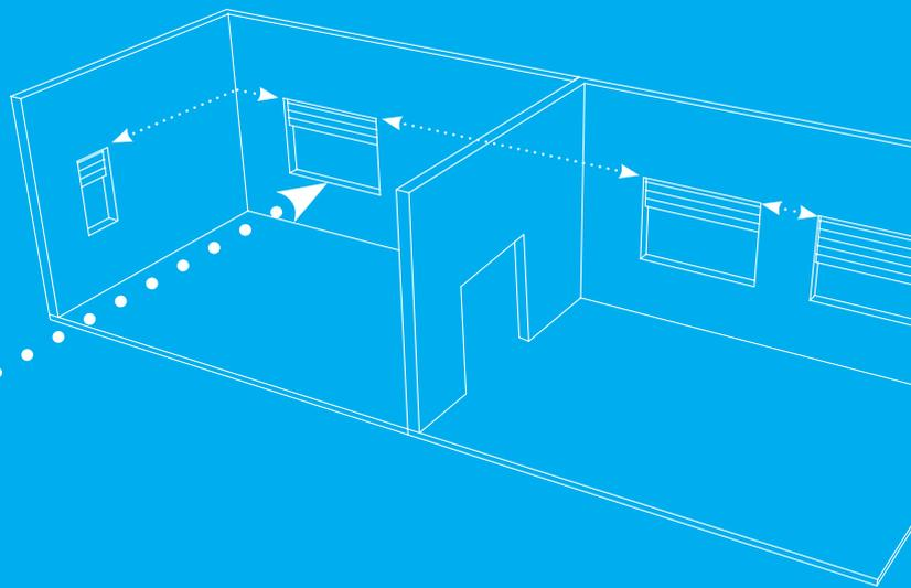
Ogni motoriduttore funziona anche come ripetitore del segnale radio; in questo modo è possibile gestire tutte le tapparelle delle diverse stanze con un solo radiocomando, da un unico punto della casa.
