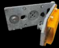
803XA-0570 Halterung für ausrastbaren Schrankenbaum, Basismodell. Beim Auffahren brechen die entsprechenden Befestigungsschrauben und der Baum fällt auf den Boden.
