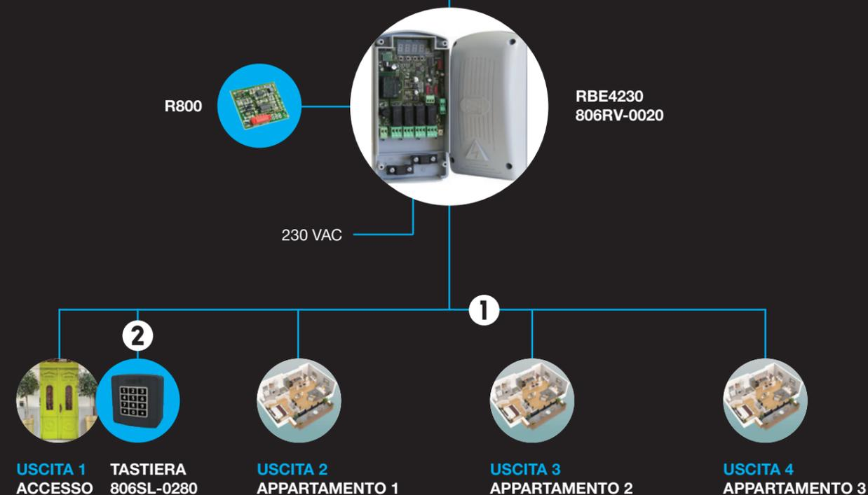
**1** Connetti le elettroserrature delle porte a RBE (via cavo fino a 4 porte)
