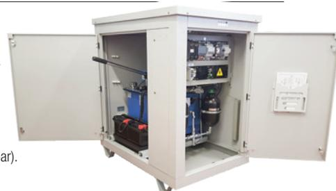
Flessibile idraulico rinforzato R2 da 10 m. (treccia a doppio filo). Verranno forniti flessibili intercollegabili per installazioni con più dissuasori. Motore, pompa idraulica ed elettrovalvole sono contenuti in un armadio in acciaio galvanizzato rifinito con verniciatura elettrostatica a polvere, facilmente accessibile, con due ante e relative doppie serrature integrate (opzione: armadio in acciaio inox).
