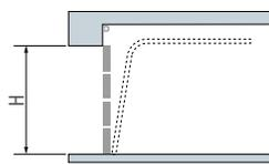
STA - SEZIONALE Tipo A con guida singola
