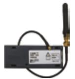
**846NC-0270** Modulo GPRS. Permette di inviare fino a 16 numeri di telefono gli eventi di centrale tramite messaggi vocale (se presente la scheda art. PXV64 o PXV256), l'invio di SMS di allarme, la ricezione di SMS e di toni DTMF per il controllo remoto. Assicura il collegamento della centrale al Cloud. Dispone di connettore per il collegamento di dongle WIFI e LAN. Assorbimento 100 mA. Dimensioni 34 x 81 x 30 mm. Conformità normativa EN 50131-3 GRADO 2 classe ambientale II. **410,00**
