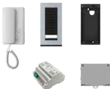
Kit citofonico monofamiliare espandibile per sistema multifilare 200, composto da citofono a parete AGT A200K, posto esterno a parete della serie Targha con un pulsante di chiamata, alimentatore A/200N munito di relè pilotato da un temporizzatore regolabile da 2 a 15 secondi tramite potenziometro.
